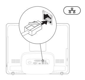
Não é necessária uma conexão de rede para concluir a configuração deste computador, mas se você já tiver uma conexão de rede ou Internet por cabo (como uma tomada de Ethernet ou modem a cabo), conecte-a agora.
